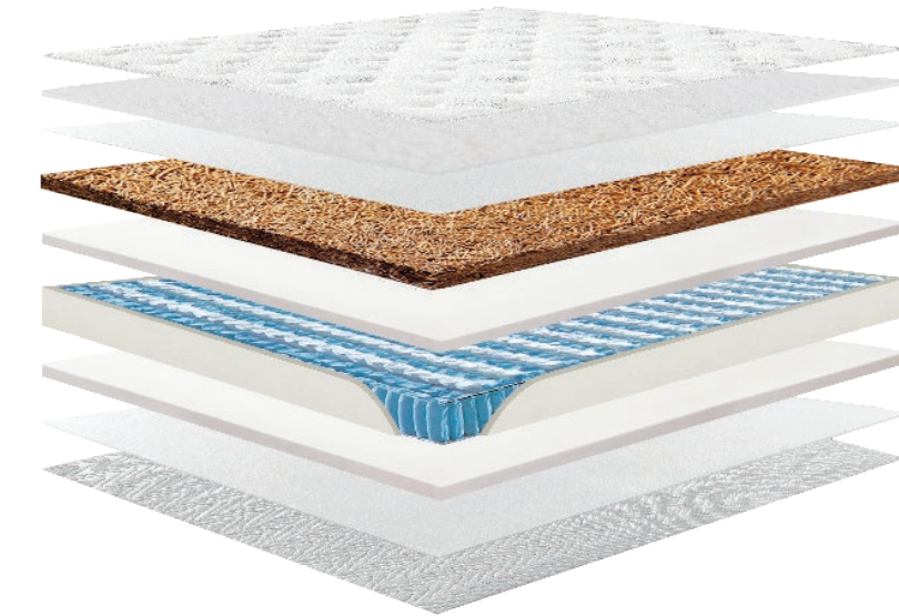
高級進口針織布 蠶絲 高白回彈海綿 馬來西亞天然軟棕 熱烘棉 獨立袋裝彈簧+四邊防撞海綿 熱烘棉 高白回彈海綿 3D面料
